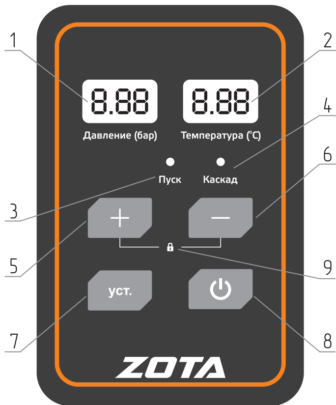
Рис. 3 Дисплей панели управления насосной станции ZOTA LaScala
